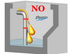
Installazione errata Wrong installation
